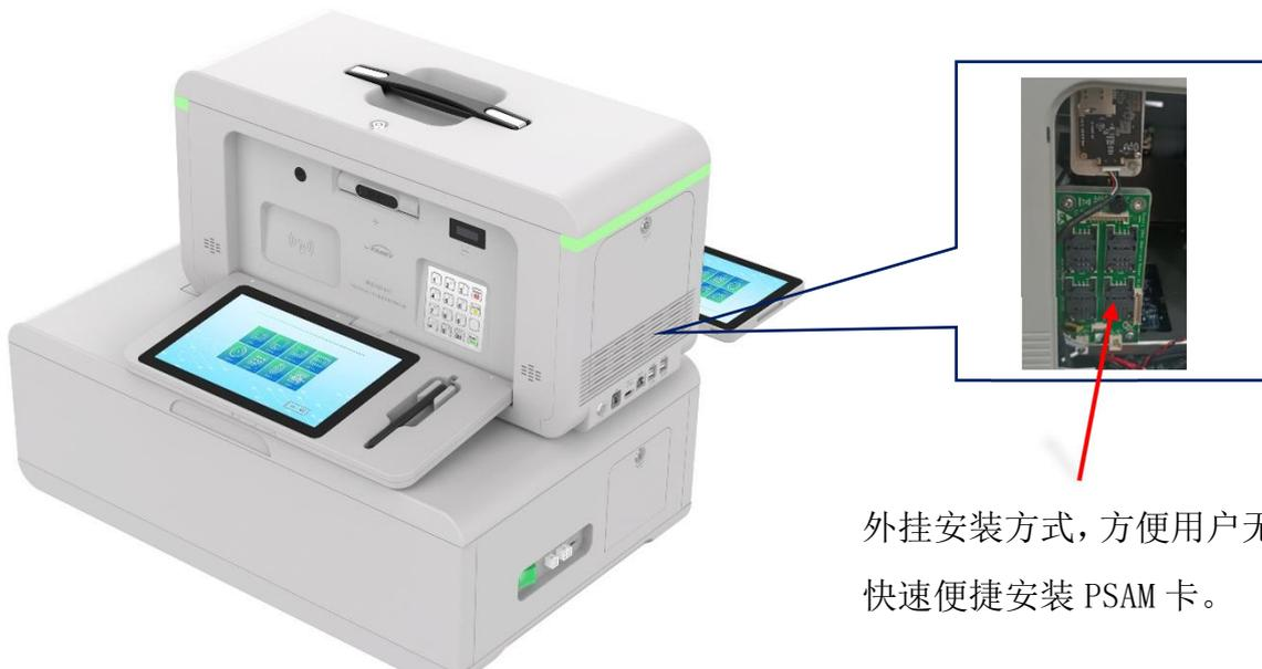
外挂安装方式，方便用户无需拆机即可快速便捷安装 PSAM 卡。
